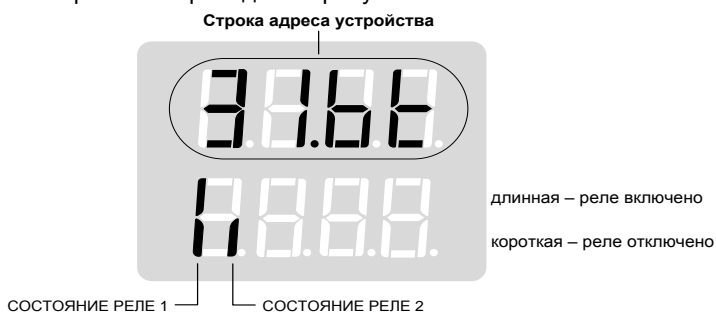
Рисунок 8 – Пример табло показывающего прибора при просмотре состояний реле БК
